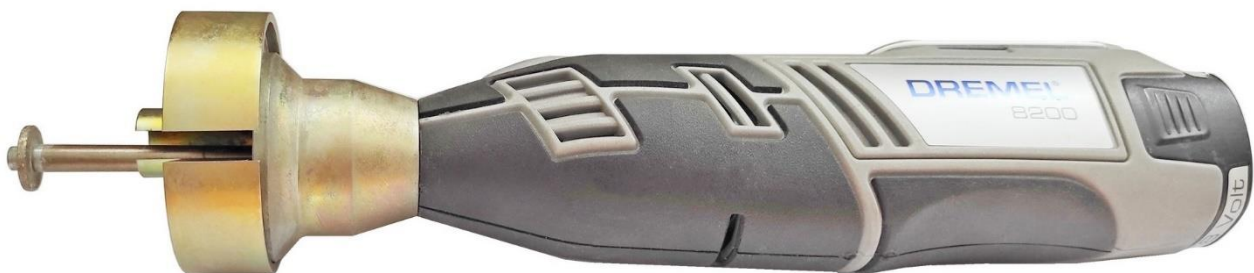
Рисунок 2 – Пример сборки расточного устройства
